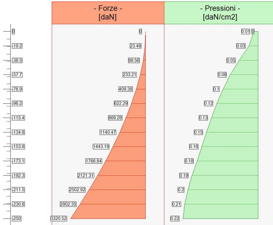
Forze (totali) e Pressioni lungo il fusto, per il Caso 2 ( GEO [ SLU_GEO ] - SLU A2+M2+R2 )
