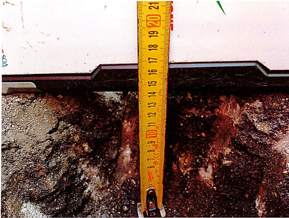
Foto 2 – spessore asfalto circa 15 cm – provino 1
