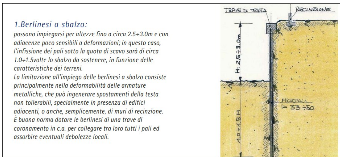
Figura 25. Sezione tipo berlinese a sbalzo
