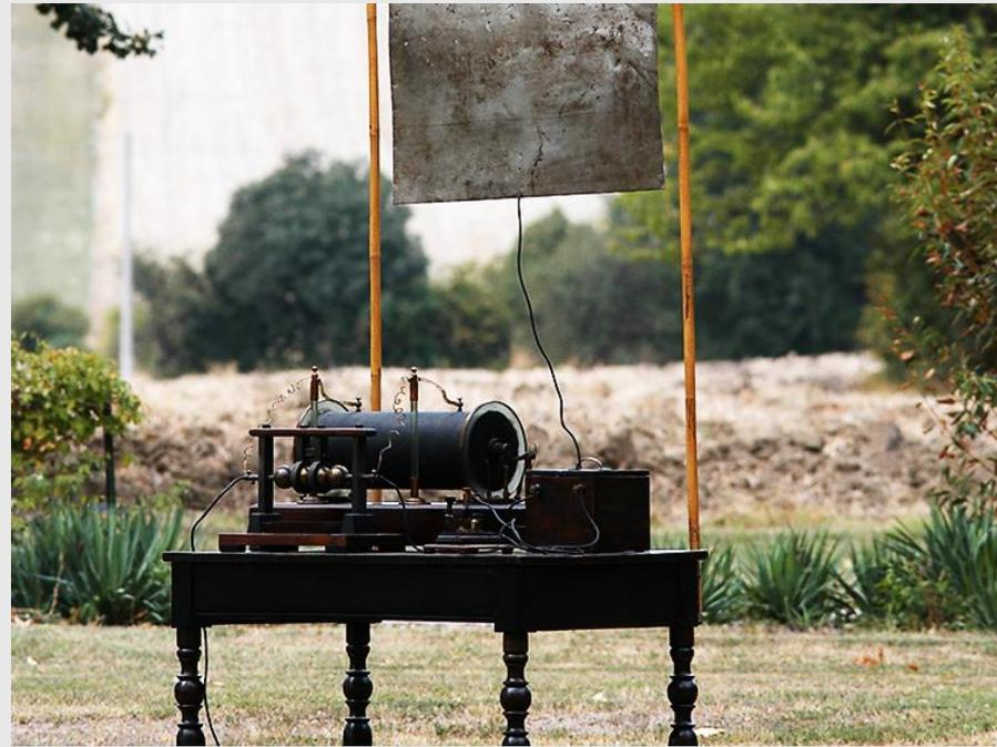
**1895** - Tavolo contenente il primo sistema di «Telegrafia wireless Marconi», con l'antenna formata da una lastra metallica e una presa di terra (Archivio Fondazione Marconi)
