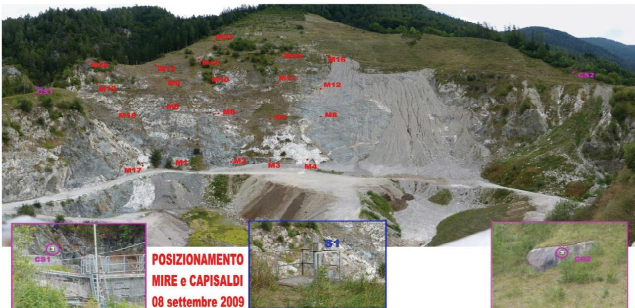
**Figura 14 Sistema di monitoraggio: posizione delle mire topografiche di superficie illustrata sulla foto panoramica del sito (RL.1145, 2012)**
