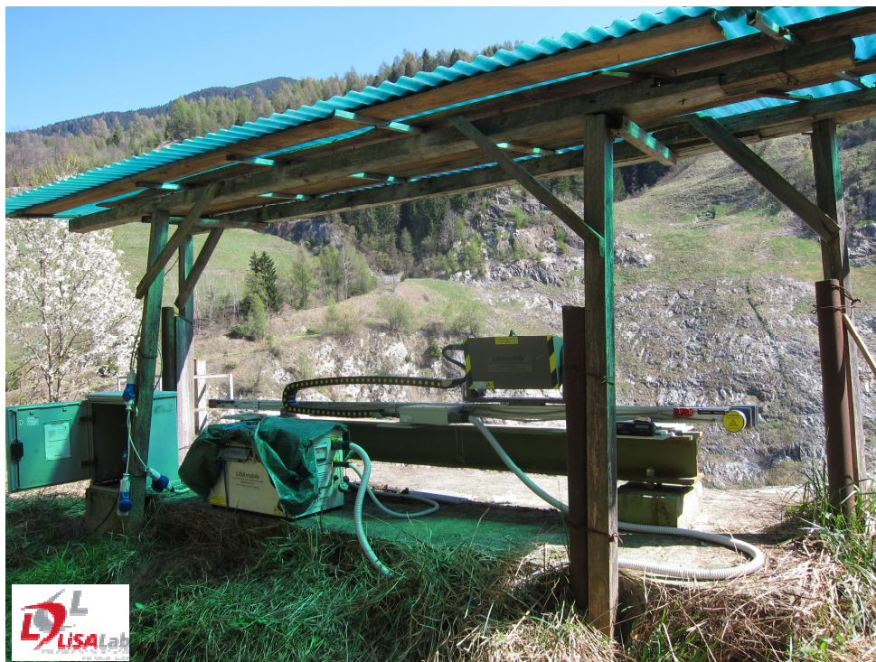
Figura 8: Postazione di misura del sistema GBInSAR LiSALab.
