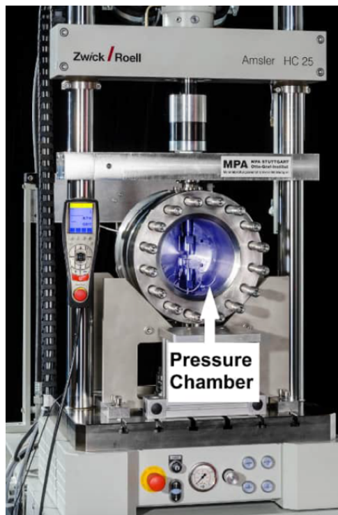
Fig. 15 – Autoclave montata sulla macchina di prova per la misura del parametro K_{IH} .
