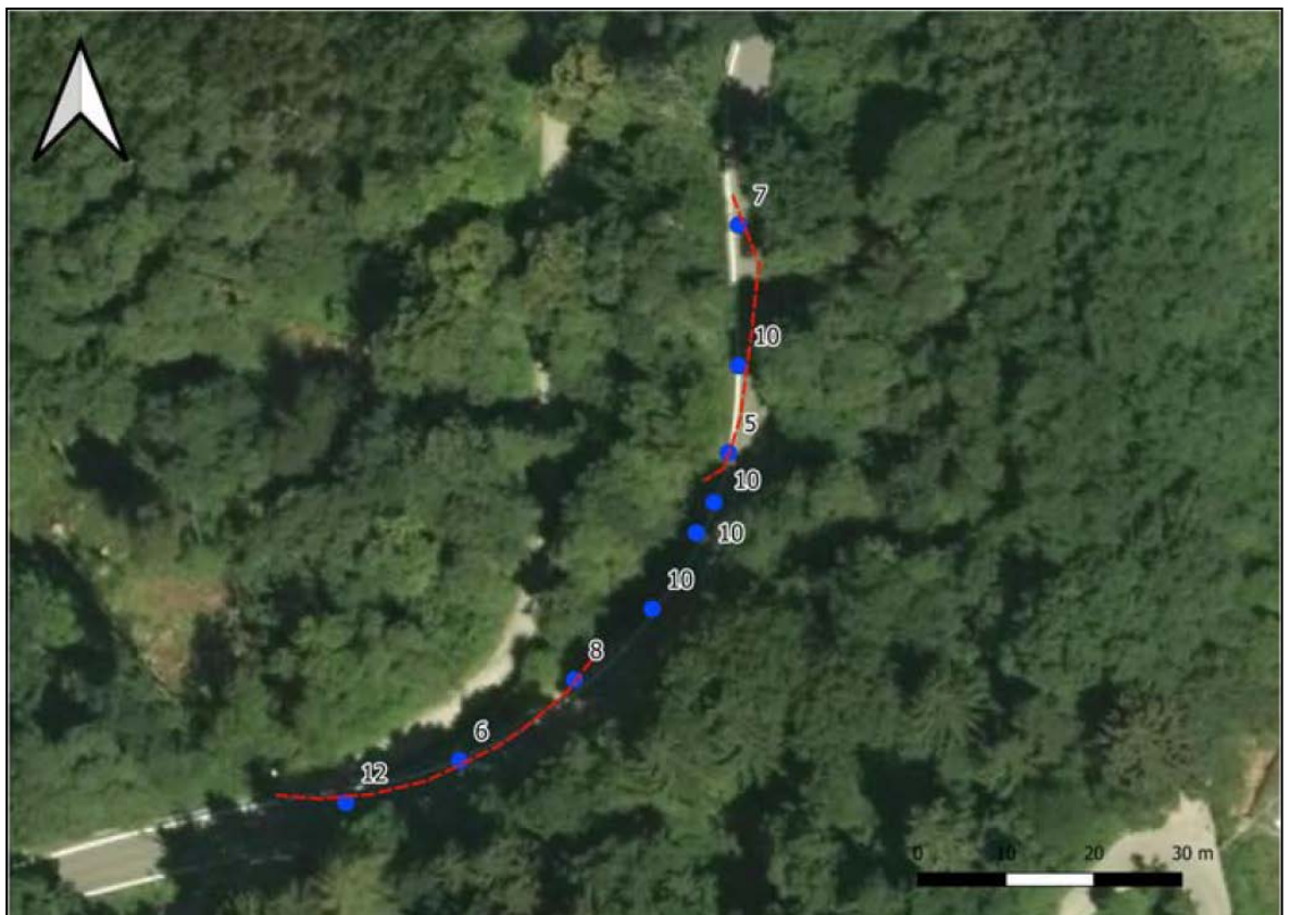
Planimetria e foto aerea con riportate le profondità del livello con V_s > 400 m/sec (substrato filladico)
