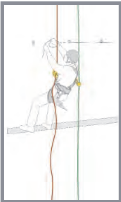
Accesso su corda per installare una linea di sicurezza fissa
