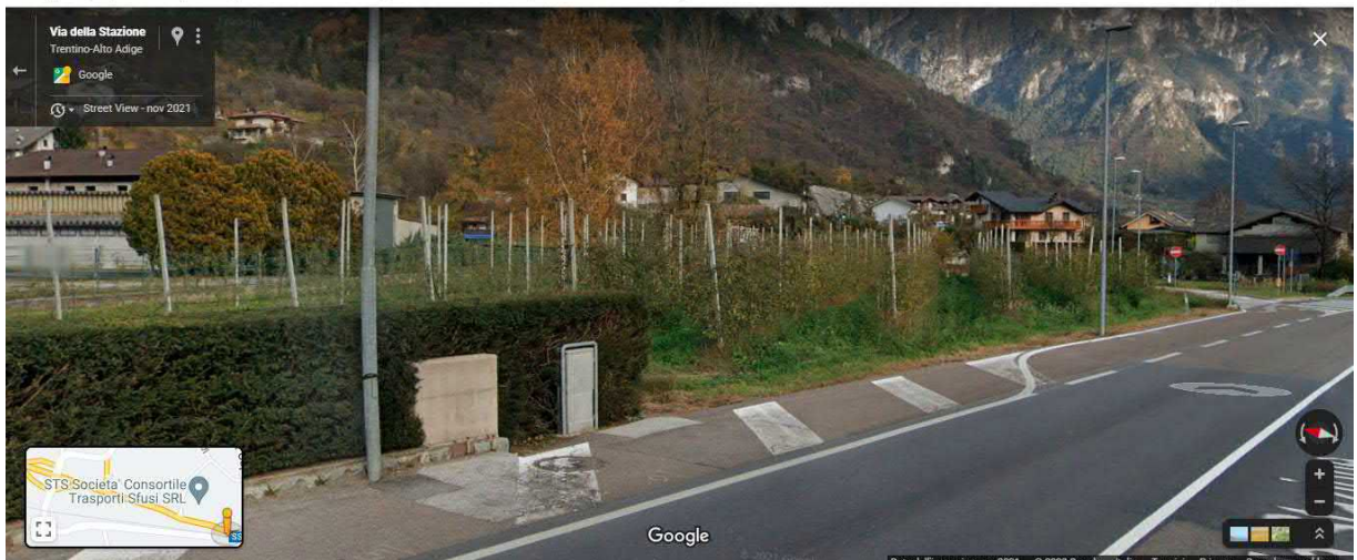
Figura 6 – Corsia di entrata esistente ma senza banchine e protezione dei margini
