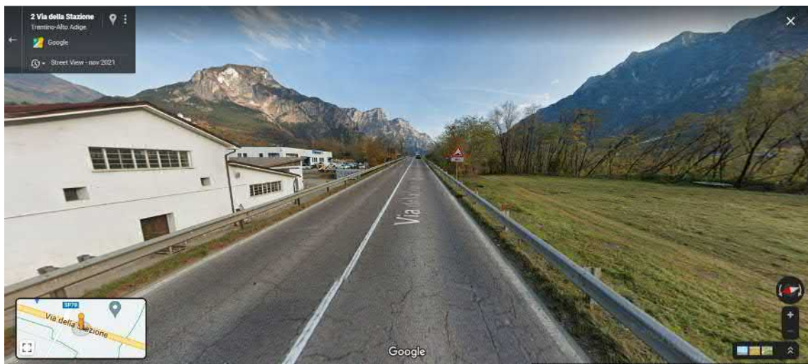
Figura 9 – Va adeguata la larghezza del margine esterno per inserimento barriera su entrambi i lati
