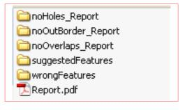
Questi shape-file possono essere caricarti nello strumento GIS con il quale è stato elaborato il Piano e permettono di individuare immediatamente l'area nella quale c'è stata violazione della regola topologica.
