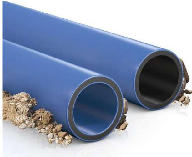
Sono prodotte con tre strati (interno blu, intermedio nero ed esterno blu) coestrusi a base di polietilene PE100 RC (MRS 10 MPa) ad elevatissima resistenza alla fessurazione (resistenza alla crescita lenta della frattura SCG>8760 ore secondo il test ISO 13479 e FNCT>8760 ore secondo il test ISO 16770).
