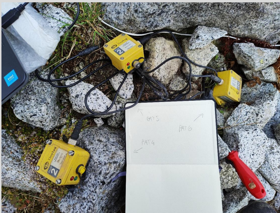
Alcuni data logger per la misura della temperatura della superficie del suolo.
