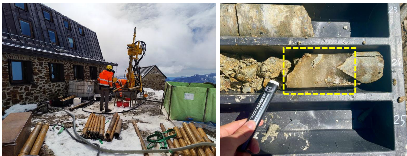
Fig. 30 – A sinistra, operazioni di perforazione del pozzo presso il rifugio Mantova al Vioz; a destra, uno dei campioni di ghiaccio estratti a circa 24 m di profondità.
