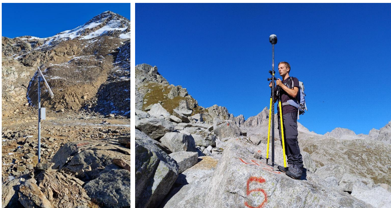
Fig. 9 – A sinistra, fotocamera installata per inquadrare il rock glacier di Cima Pontevecchio; a destra, operazioni di rilievo della cinematica del rock glacier di Val d'Amola.
