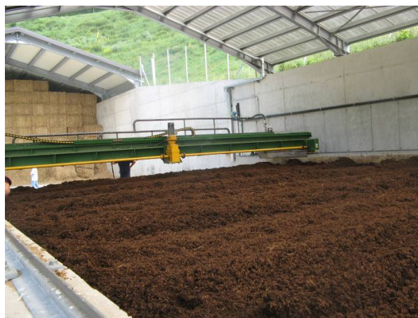
Fig. 4: esempio di trattamento aerobico del digestato
